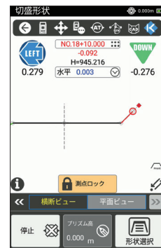
実際の丁張設置作業中の画面
